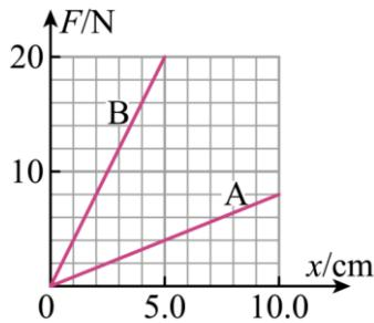
(1) 由图求得弹簧 B 的劲度系数为\_\_\_\_\_ N/m;
